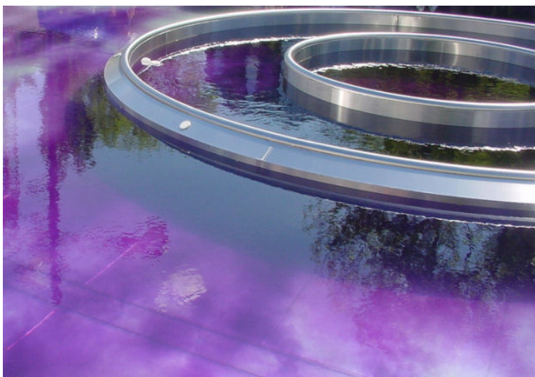
L'épreuve de coloration montre l'effluation du bassin
