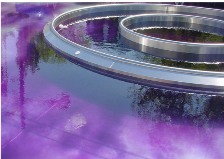
Der Färbeversuch dokumentiert die Beckendurchströmung
